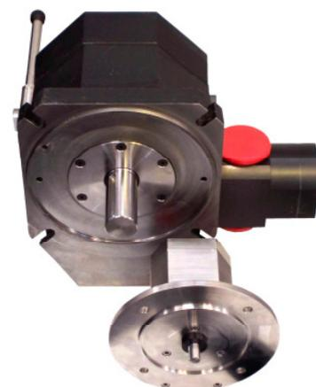
Das Drehmoment wird aufgebaut in einem Drehkolben. Durch ein Synchronisiergetriebe wird es auf die Abtriebswelle mit dem Dichtungsrotor übertragen. Kolben und Rotor laufen berührungsfrei mit sehr engen Toleranzen und geringen Verlusten. Das ist **Garant für langen, störungsfreien Dauerbetrieb ohne Stillstandzeiten**. Die geschlossene Motorausführung gewährleistet sicheren Betrieb in jeder Umgebung.
